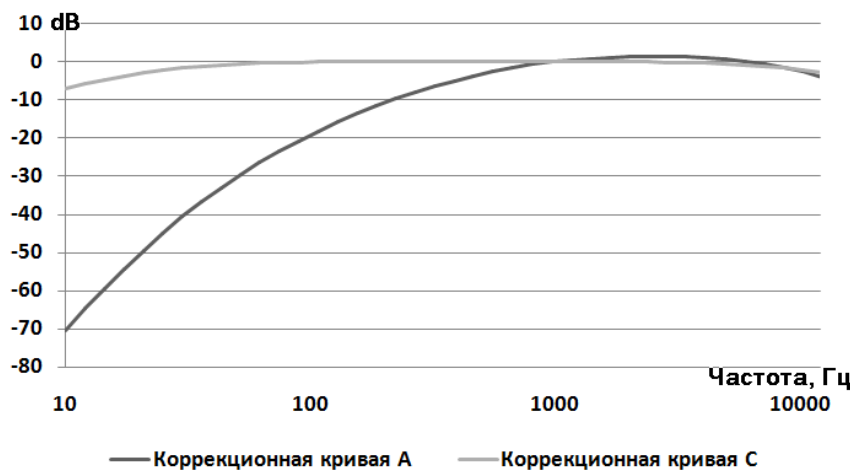
Рис. 3. Коррекционные кривые для измерений уровней звука А и С Fig. 3. A-weighting and C-weighting correction curves
